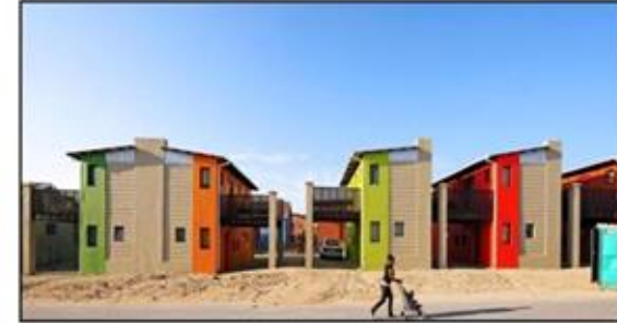
FIGUUR 8a: MMA Argitekthe, Sandsak Huise , Freedom Park, Kaapstad, Suid-Afrika, houtbalke en sandsakke, 2007.
